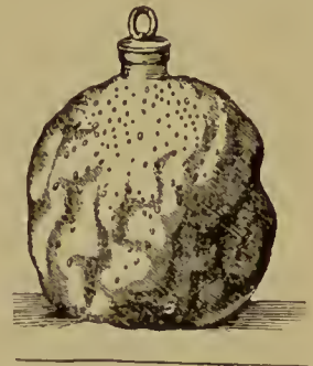
Abb. 26. Versuch der Akademiker über die Zusammendrückbarkeit des Wassers 4) .
